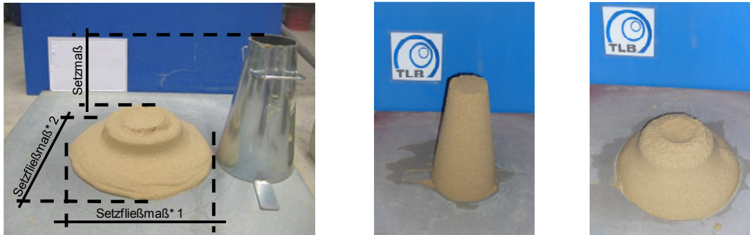
Versuchsaufbau zur Bestimmung des Setzmaßes und Setzfließmaßes* von konditionierten Böden
