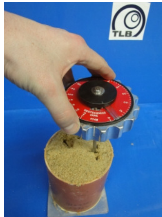
Abbildung 4-32: Flügelsonde zur Bestimmung der Flügelscherfestigkeit von konditionierten Böden
