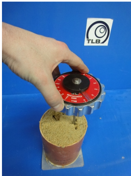
Versuchsaufbau zur Bestimmung der Flügelscherfestigkeit von konditionierten Böden
