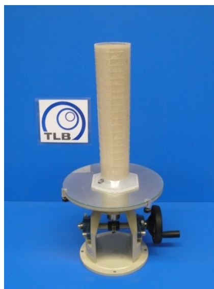
Versuchsaufbau zur Bestimmung der Stabilität von konditionierten Böden
