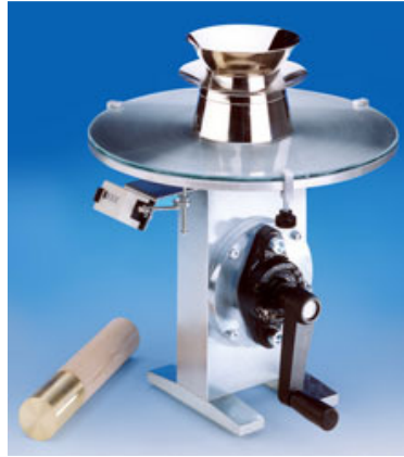
Versuchsaufbau zur Bestimmung des Ausbreitmaßes von konditionierten Böden
