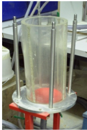
Abbildung 4-30: Plexiglaszylinder mit abgenommenem Deckel zur Bestimmung der Kompressibilität nach [134]
