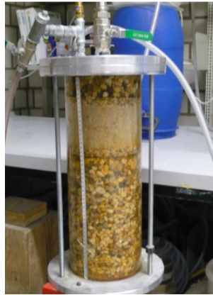
Abbildung 4-28: Plexiglaszylinder zur Bestimmung der Wasserdurchlässigkeit von Boden-Schaum-Gemischen nach [83]
