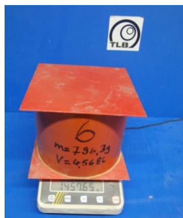
Versuchsaufbau zur Bestimmung der Dichte von konditionierten Böden mit einem Größtkorn größer 8 mm
