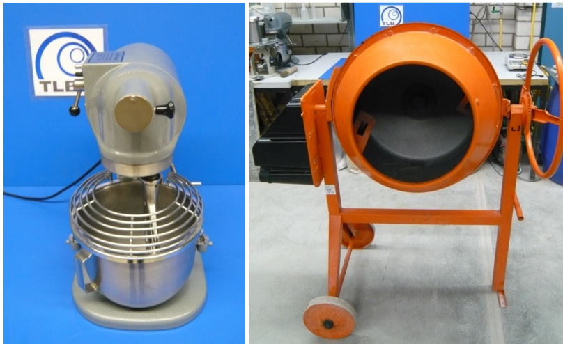
Abbildung 6-3: Bei Untersuchungen genutzte Planetenmischer (links, Fa. Hobart GmbH) und Freifallmischer (rechts, Fa. Atika GmbH & Co. KG)
