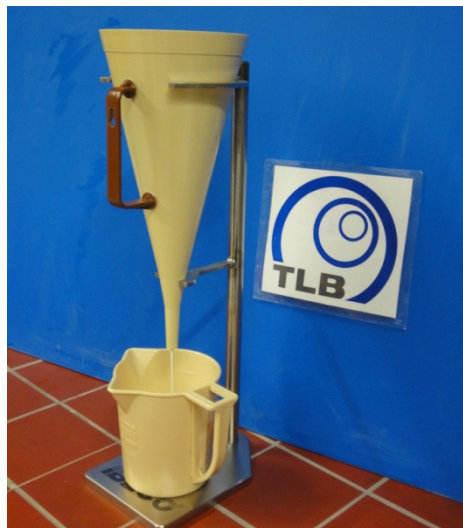
Versuchsaufbau zur Bestimmung der Marsh-Zeit von Polymeren und Polymersuspensionen
