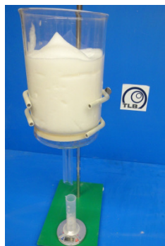
Verwendeter Trichter zur Bestimmung der Drainagezeit bei Schäumen
