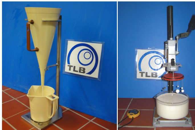
Abbildung 4-16: Versuchsaufbau zur Bestimmung der Marsh-Zeit sowie der Kugelnummer mit der Kugelharfe nach von Soos
