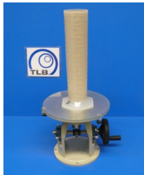
Abbildung 4-34: Versuchsaufbau zur Bestimmung der Stabilität von Böden nach [83]
