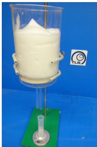
Abbildung 4-9: Versuchsaufbau zur Bestimmung der Drainagezeiten von Schäumen
