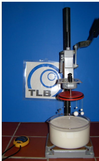
Versuch mit der Kugelharfe nach von Soos für Polymere und Polymersuspensionen
