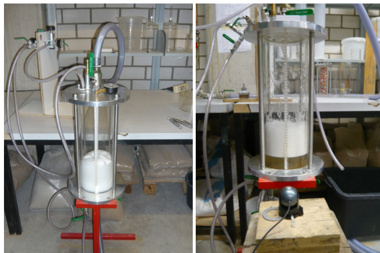
Versuchsaufbau zur Bestimmung der Kompressibilität von Schäumen
