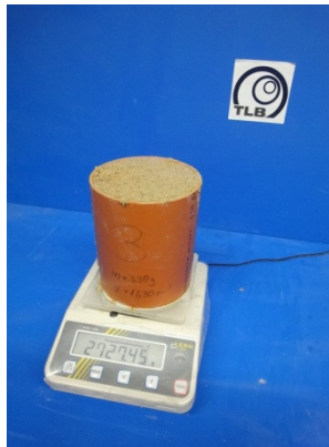
Versuchsaufbau zur Bestimmung der Dichte von konditionierten Böden
