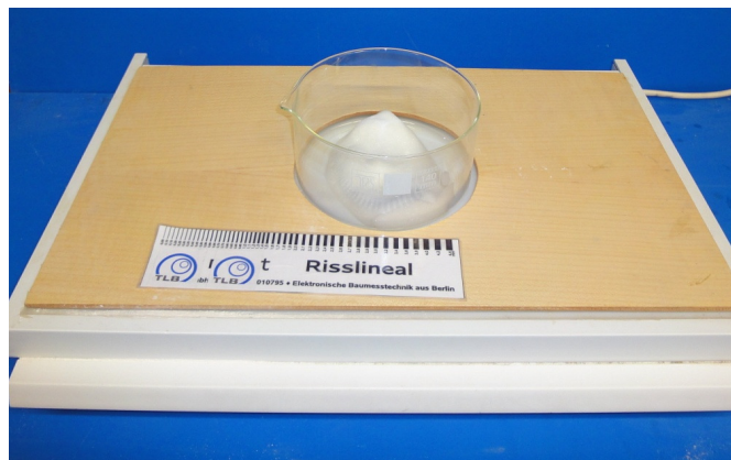
Versuchsaufbau zur Bestimmung der Bläschengröße von Schäumen mit dem Risslineal
