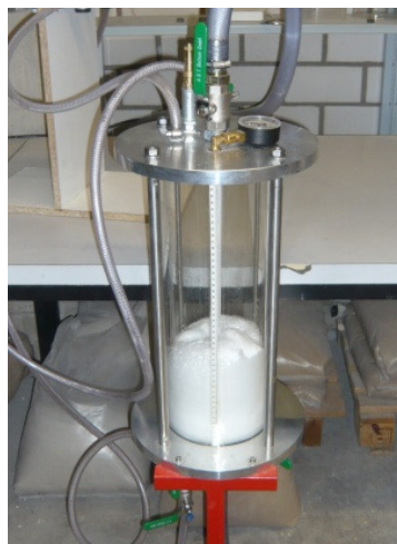
Abbildung 4-14: Druckbehälter zur Bestimmung der Kompressibilität von Schäumen
