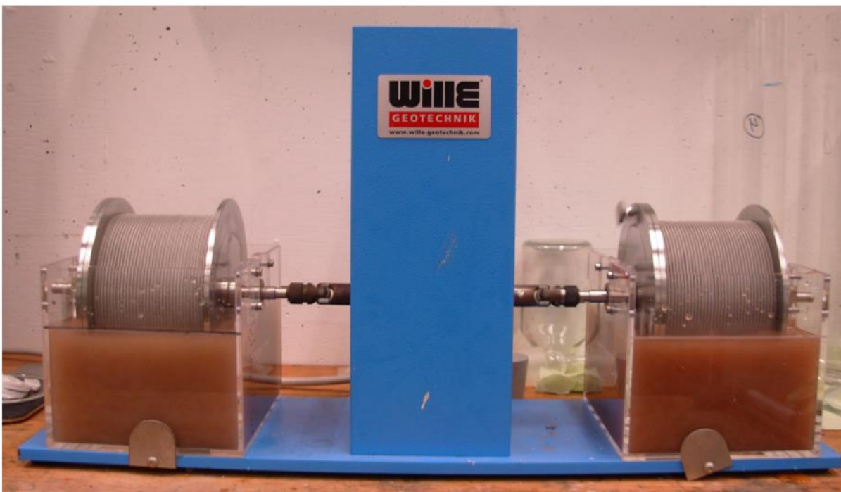
Abbildung 5.2: Apparatur zum Siebtrommelversuch nach Durchführung eines Versuchs mit deutlicher Verfärbung des Wassers innerhalb der Tröge infolge des Zerfalls (Foto aus Masterarbeit von Weiz [122])
