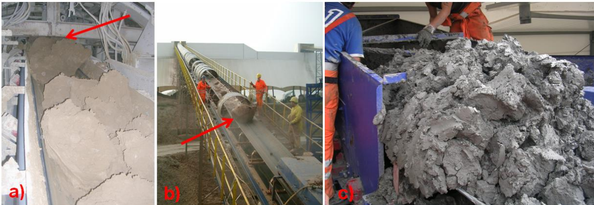
Abbildung 6.96: a) Materialstaus (Pfeil) auf Förderband infolge von Zusammenballungen aus steifem Ausbruchsmaterial b) In Form von großen Kugeln (Pfeil) zurückrollendes Verklebungsmaterial auf Steigband [3] c) Durch weiches Ausbruchsmaterial verstopfte Bandübergabe
