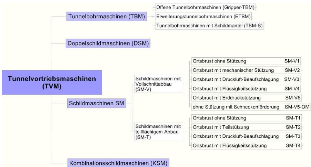
Abbildung 2.1: Einteilung der Tunnelvortriebsmaschinen [19]
