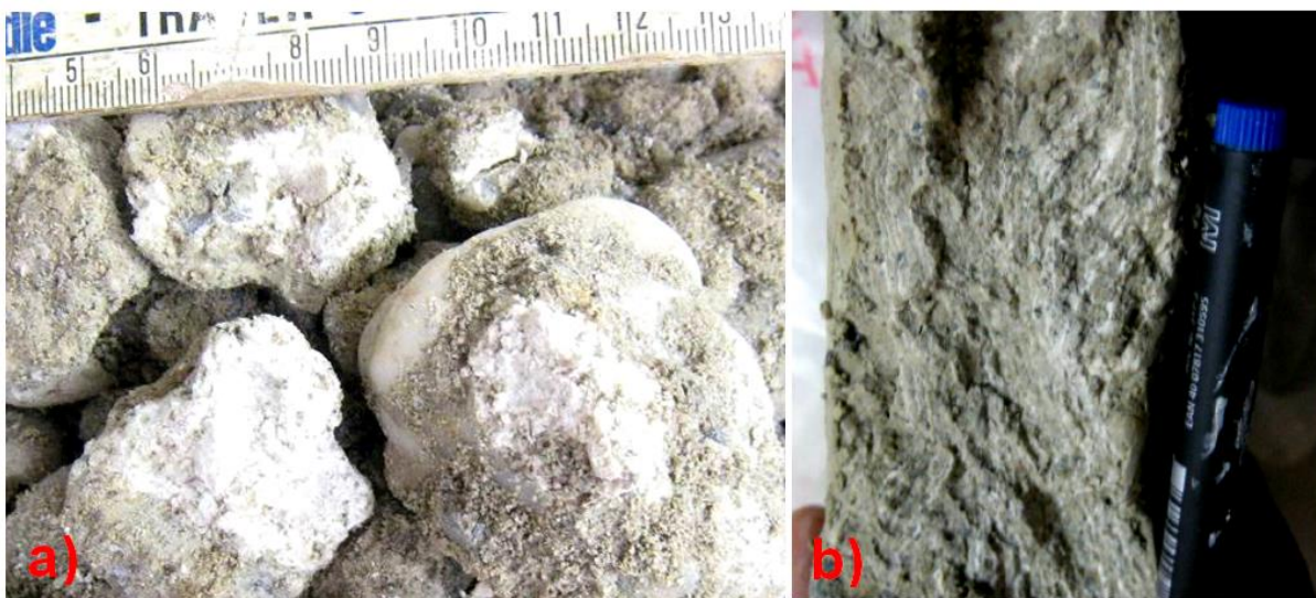
Abbildung 6.84: a) Anhaftungen von Gesteinspulver an Kieskörnern einer Ortsbrustprobe [59] b) Verklebungsmaterial von der Schneidradvorderkante mit weißlichen Lagen aus Gesteinspulver. Der Stift ist parallel zur Ortsbrust ausgerichtet, so dass sich die einzelnen Lagen senkrecht dazu angelagert haben [59, modifiziert]
