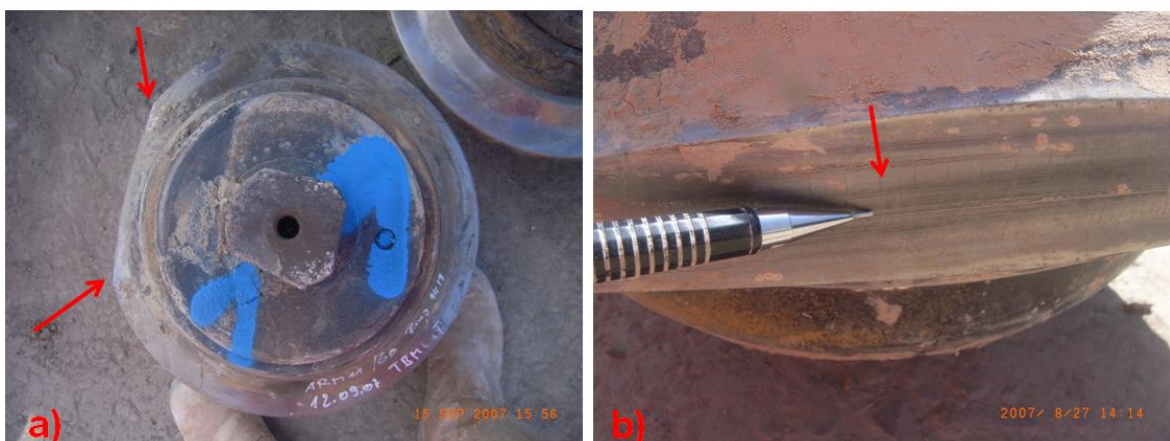
Abbildung 6.105: a) Einseitiger Abschleiß (Pfeile) des Schneidrings eines blockierten Rollenmeißels b) Blick auf die abgeschliffene Schnittkante des Schneidrings eines Rollenmeißels
