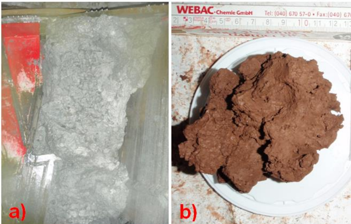
Abbildung 6.50: Verklebungsmaterial aus dem Bereich des Hydroschildvortriebs. a) Im Bereich einer Schneidradöffnung. b) Probe von weichem Verklebungsmaterial
