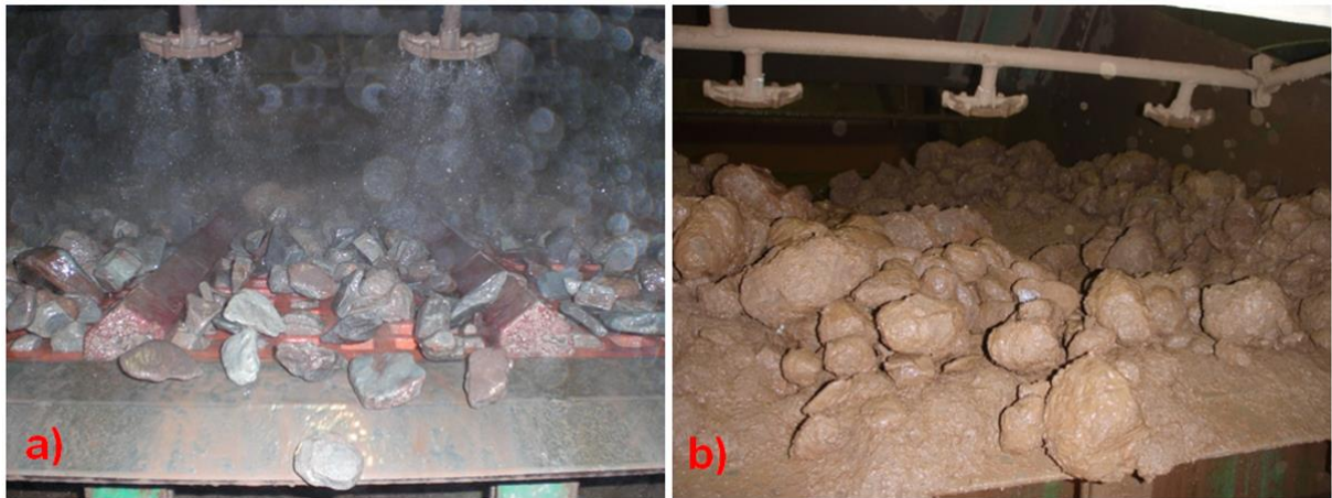
Abbildung 6.8: Material auf den Grobsieben eines Hydroschildvortriebs a) Überwiegend Gesteinsbruchstücke b) Überwiegend bindige Kugeln als sekundäres Verklebungsmaterial (vgl. Kap. 3.1.2)
