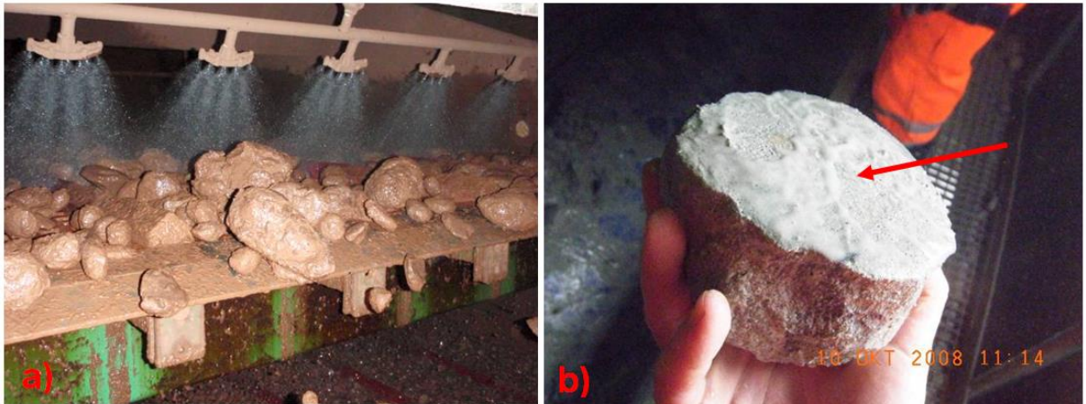
Abbildung 6.99: a) Bedüsung des oberen Grobsiebs [60]. b) Schmierschicht mit flüssig bis breiiger Konsistenz (roter Pfeil) an der Unterseite einer Verklebungskugel [60]
