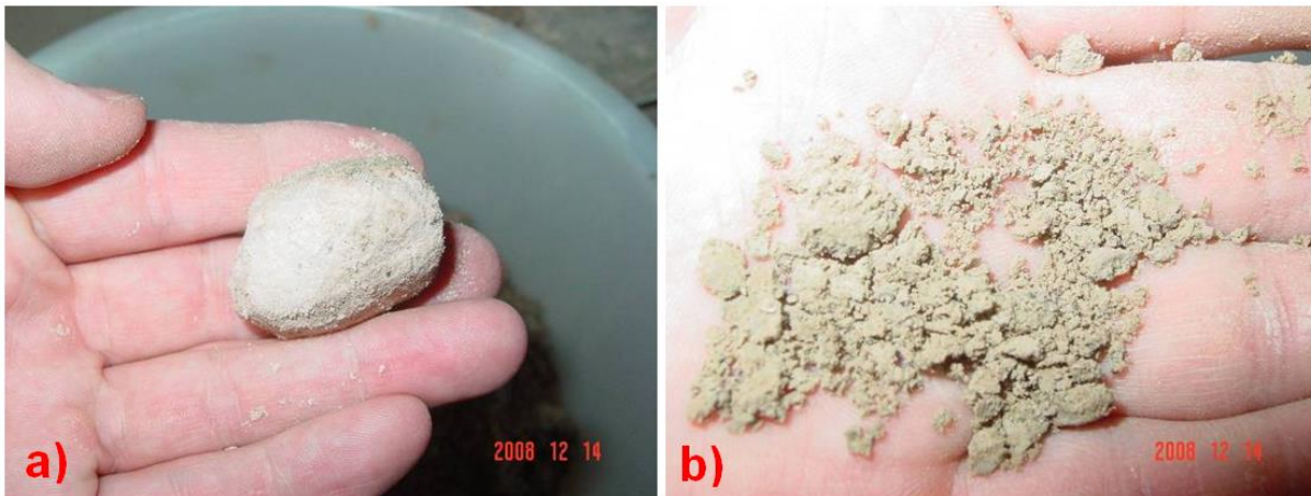
Abbildung 6.83: a) Intaktes Korn eines veraschten Dolomits aus einer Kiesprobe b) Mit leichtem Fingerdruck zerriebener Dolomit [59]
