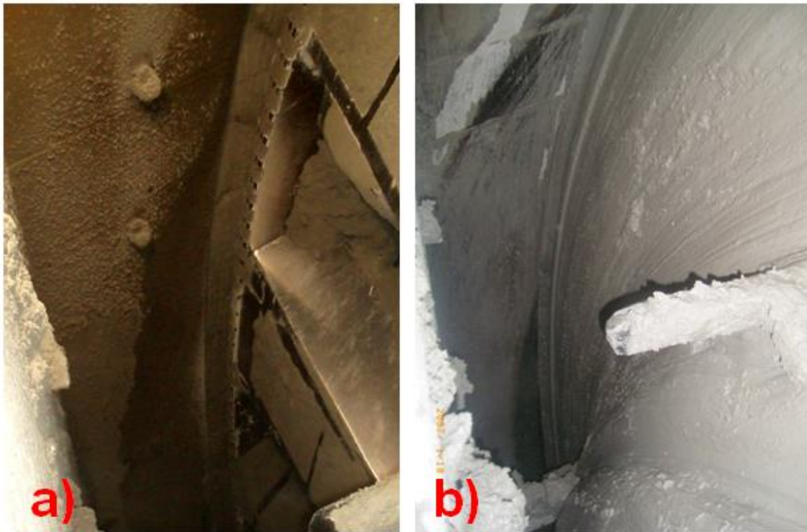
Abbildung 6.90: a) Schneidradrückseite mit wenig Verklebungen (Vergleichsfoto) b) Komplett bis über die Rückseite des Schneidrads angewachsene Verklebungen ("Töpferscheibe") [3]
