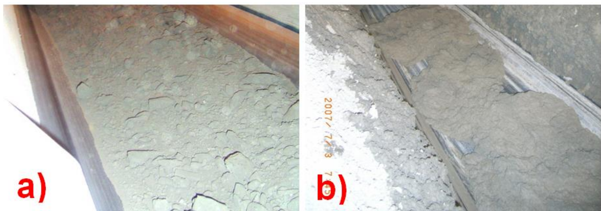
Abbildung 6.24: Vergleich von nicht konditioniertem Ausbruchsmaterial mit Erdbrei a) Förderband mit trockenem Ausbruchsmaterial im offenen Modus. b) Förderband mit Erdbrei im geschlossenen Modus
