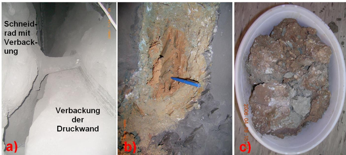
Abbildung 6.40: a) Schälspur des Agitators in einer relativ trockenen Verbackung b) Schichtartiger Aufbau einer Verklebung/Verbackung an der Druckwand nach Baugrundwechsel (außen: schwarzes, trockenes Material, Mitte: hellbraunes, trockenes Material, innen braunes, steifes Material) c) Probe einer festen Verbackung [67]
