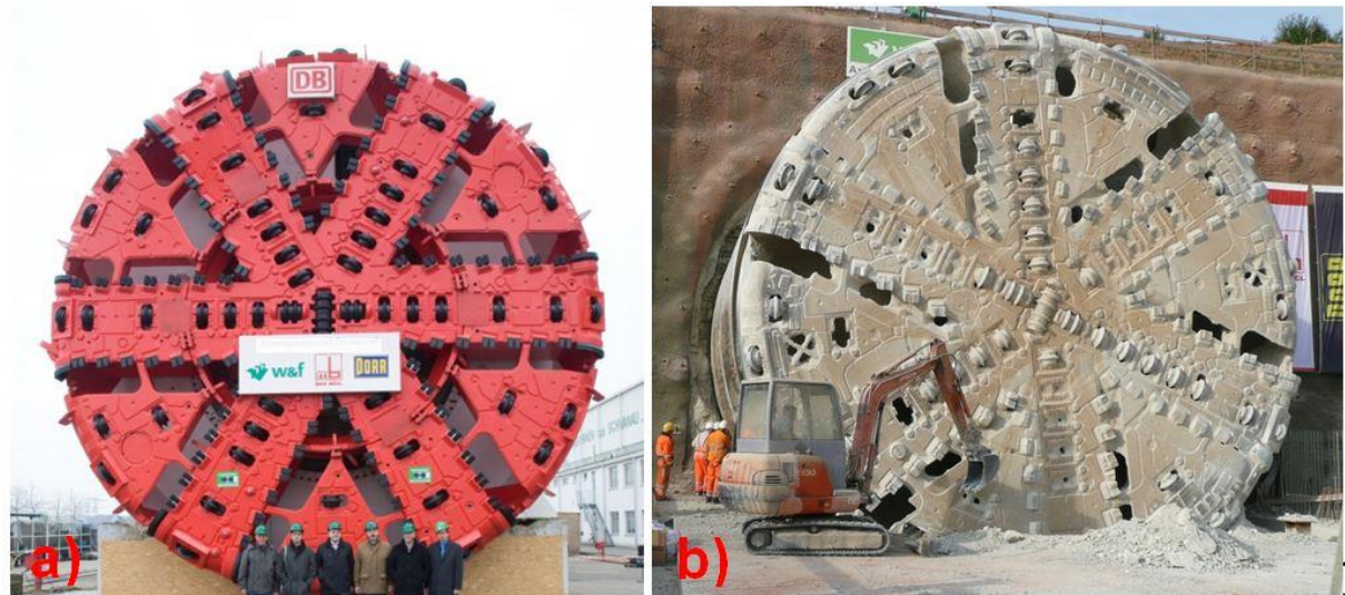
Abbildung 6.42: a) Schneidrad vor Vortriebsbeginn b) Schneidrad nach Vortriebsende
