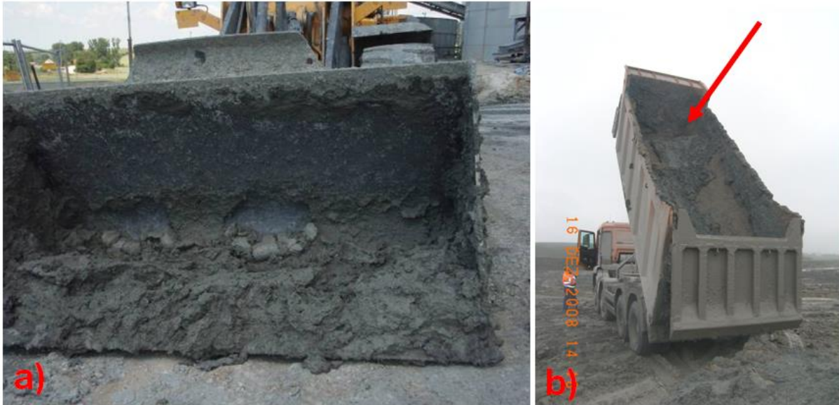
Abbildung 6.100: a) Verklebungen im Bereich einer Laderschaufel [60] b) Verklebungen der Ladefläche eines LKWs [60]
