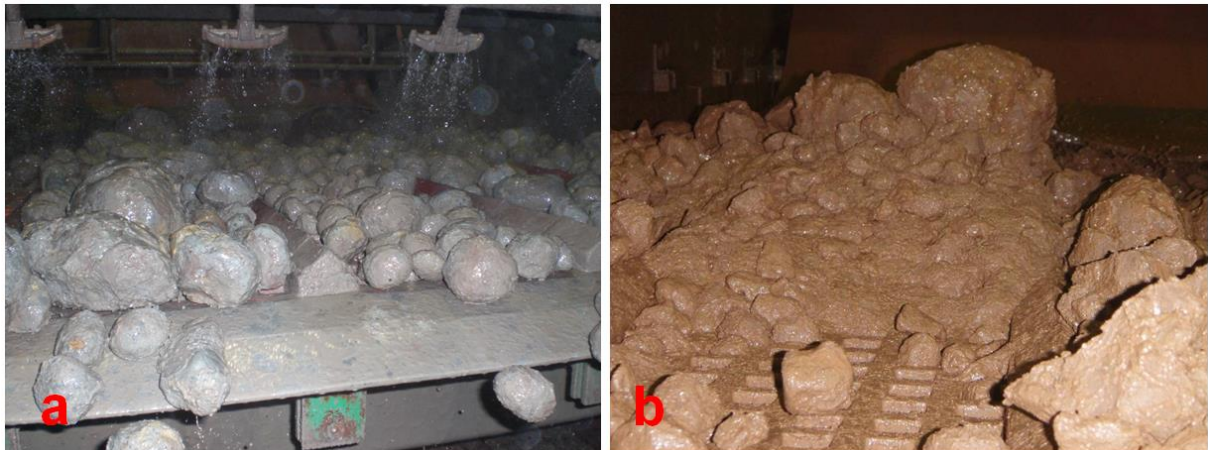
Abbildung 3.2: Verklebungsmaterial auf der Separation [61] a) Grobsieb mit Kugeln aus Verklebungsmaterial b) Sekundäre Verklebungen des Grobsiebs durch Zusammenballungen klebriger Kugeln
