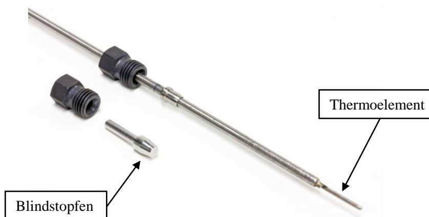
ABBILDUNG 4-10 THERMOELEMENT TYP K, EINGELÖTET IN EIN HOCHDRUCKROHR MIT SCHNEIDRINGVERSCHRAUBUNG SOWIE BLINDSTOPFEN ZUM VERSCHLIEßEN UNGENUTZTER ANSCHLÜSSE AM MESSFLANSCH.
