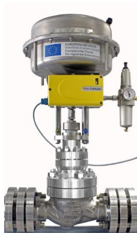
ABBILDUNG 4-7 DROSSEL MIT VIERSTUFIGEM Z-KEGEL FÜR DEN DRUCKABBAU UND PNEUMATISCHEM STELLANTRIEB SOWIE EINEM STELLUNGSREGLER LOGIX 510SI
