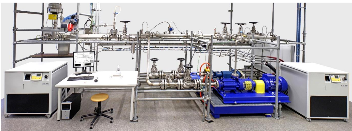
ABBILDUNG 4-3 VERFAHRENSTECHNISCHER STRÖMUNGSPRÜFSTAND ZUR UNTERSUCHUNG VON PUMPENKENNLINIEN SOWIE DRUCKVERLUSTEN AN ROHREINBAUTEN (WIE Z.B. FESTBETTSCHÜTTUNGEN)
