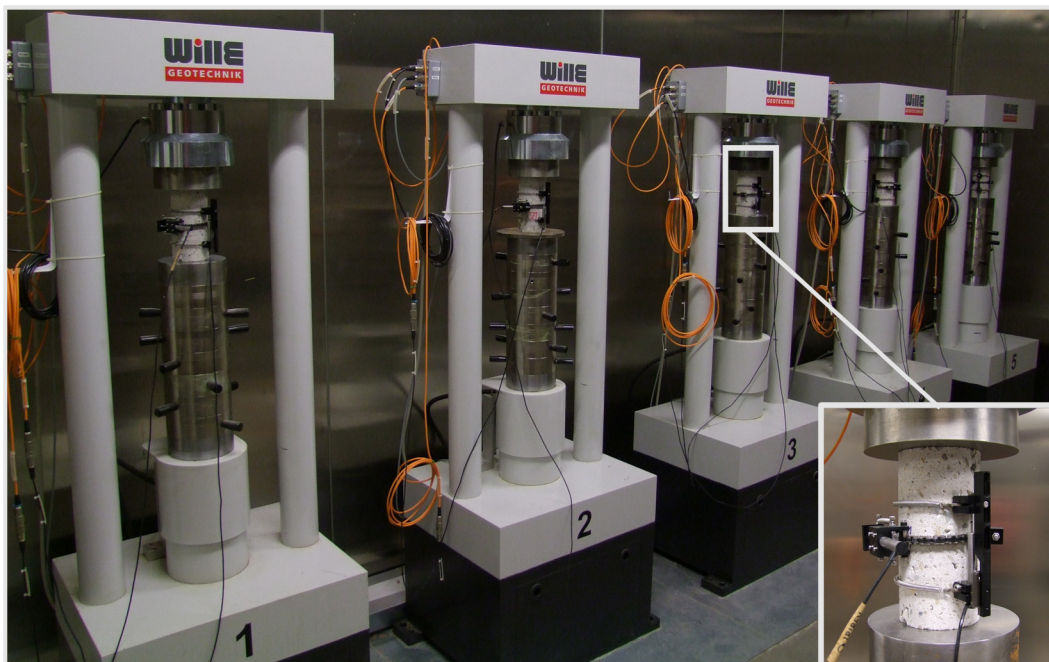
Abbildung 70: Eingebaute Bohrkernbohrkerne ( b_{BK}/h_{BK} = 80 \text{ mm}/160 \text{ mm} ) in einaxialer Langzeitdruckprüfmaschine der Montanuniversität Leoben, Lehrstuhl für Subsurface Engineering bei einer Umgebungstemperatur von 15 °C und einer relativen Luftfeuchtigkeit von 65 % (Lehrstuhl für Subsurface Engineering)
