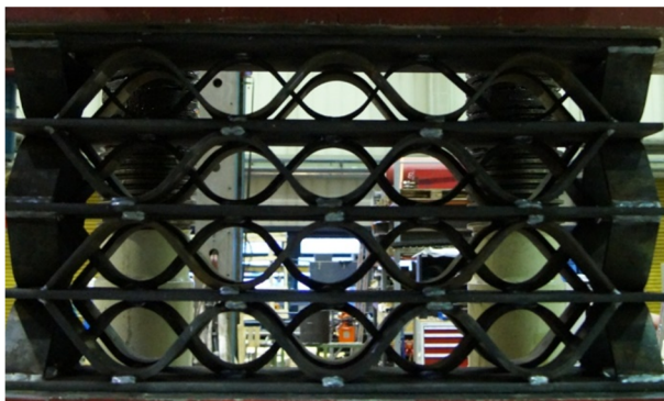
Abbildung 40: Stauchelement SZ vor und nach Stauchversuch (Alawieh, 2016)
