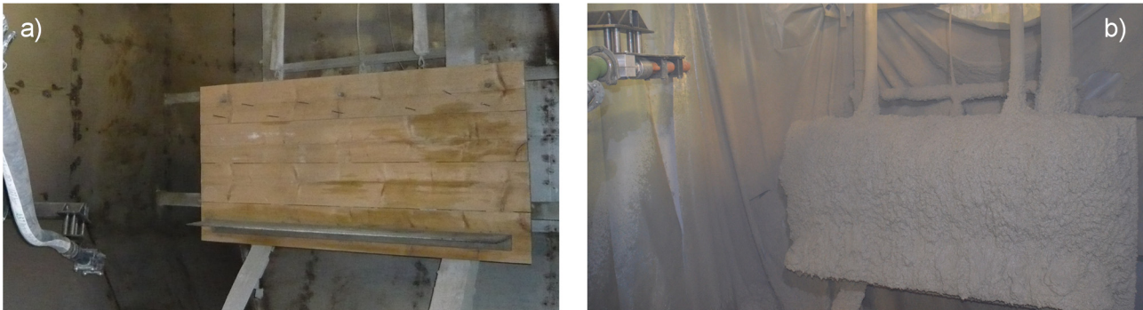
Abbildung 66: (a) Spritzbetonpalette wird hergestellt und (b) gespritzte Palette
