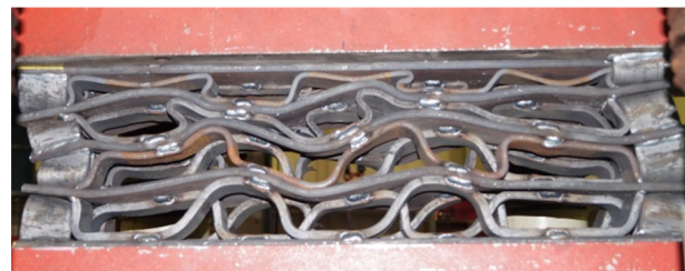
Abbildung 40: Stauchelement SZ vor und nach Stauchversuch (Alawieh, 2016)
