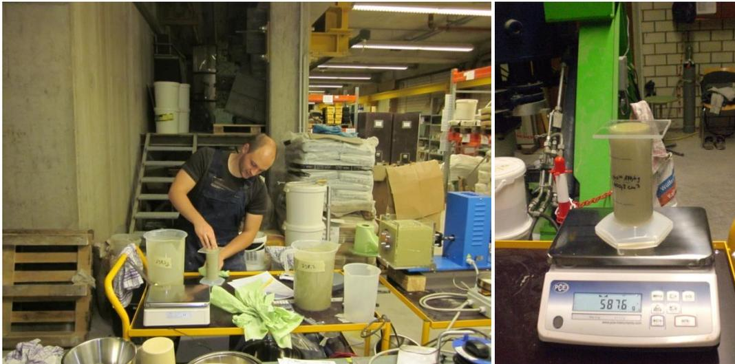
Abbildung 22: Bestimmung Dichte  $\rho_{sus,1}$
