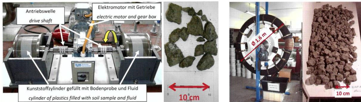
Abbildung 11: Hydraulischer Zerfallsindexversuch (li) und Radreifenversuch (re) [5]
