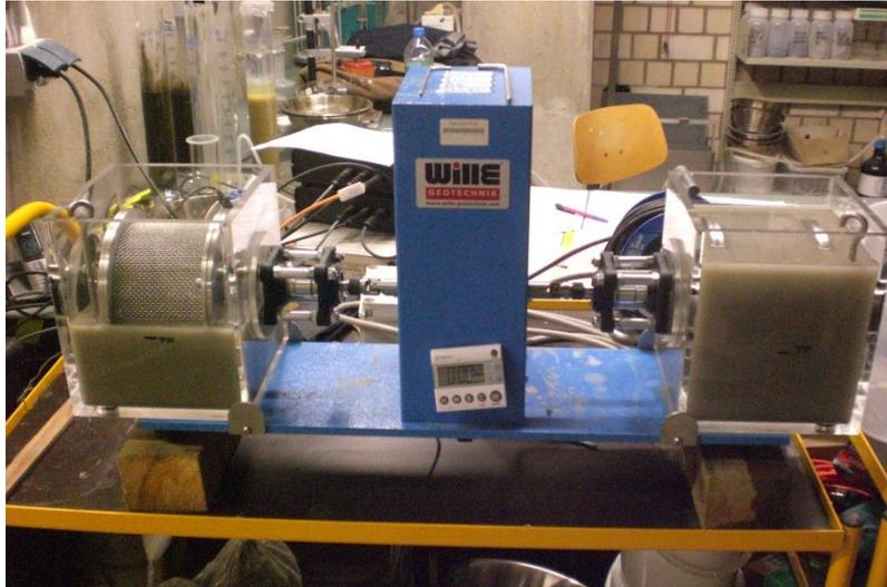
*Abbildung 25: Teilfüllung (links) und Vollfüllung (rechts)*
