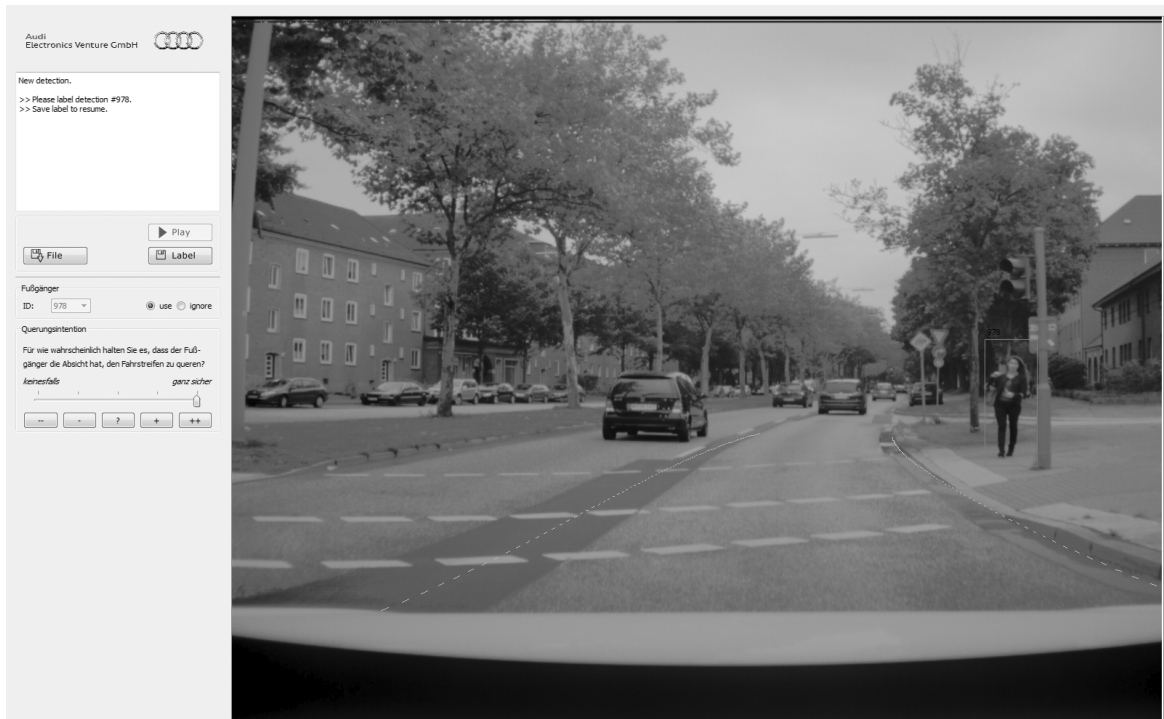
Abbildung 4.2: Das PCI_Labeltool: rechts ist der Videobereich mit der zu bewertenden Fußgängerdetektion und dem eingezeichneten Ego-Fahrstreifen zu sehen. Links befindet sich ein Informations-, Steuer- und Bewertungsbereich (von oben nach unten).
