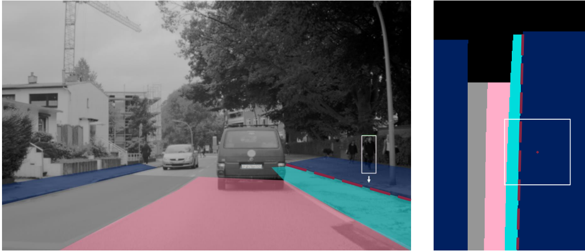
Abbildung 5.3: Beispielhafte Segmentierung einer Szene mit einer Ego-Zone ( Z_{ego} , Pink), einer Straßen-Zone ( Z_{str} , Grau), einer Gemischten-Zone ( Z_{mix} , Cyan) und zwei Gehweg-Zonen ( Z_{swk} , Blau). Das weiße Rechteck im rechten Bild repräsentiert die Kontur des an der Position des Fußgängers (rotes Kreuz) zentrierten, relevanten Szenenausschnitts. Die rote gestrichelte Linie markiert die relevante Fahrstreifengrenzen.
