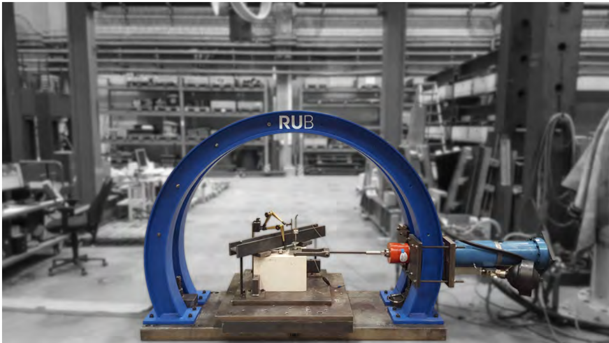
Abbildung 4.10: Triaxialer Versuchsstand im Set-up für Konfiguration E-90-0
