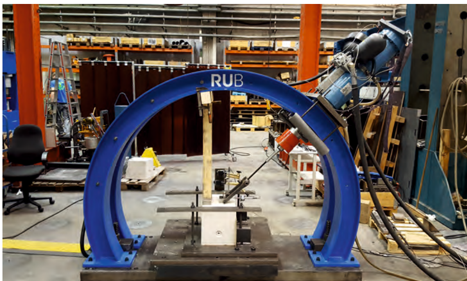
Abbildung 4.16: Behelfslösung zur zusätzlichen Abspannung des hinteren Bauteilrandes
