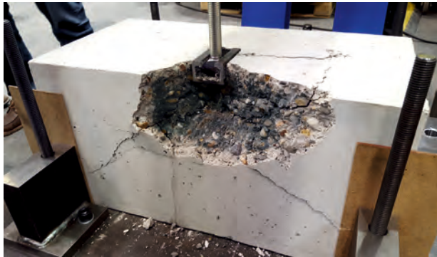
Abbildung 4.17: Versagensbild und Traglast F_{max} im Versuch PK 5
