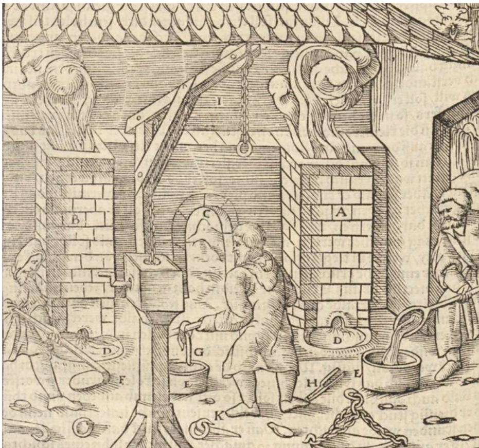
**Abb. 2.16** Das Legieren des Kupfers mit Blei („Frischen“) im Schmelzofen. Der Ofen links ist dabei für das Schwarzkupfer, der Ofen rechts für Schlacken gedacht. Im Vordergrund rechts wird die Schmelze aus dem Vorherd des Ofens (D) in eine kupferne Form (E) gefüllt. Hier entstehen die sog. Frischstücke, eine Kupfer-Blei-Silber Legierung (Nach Agricola, 1556).
