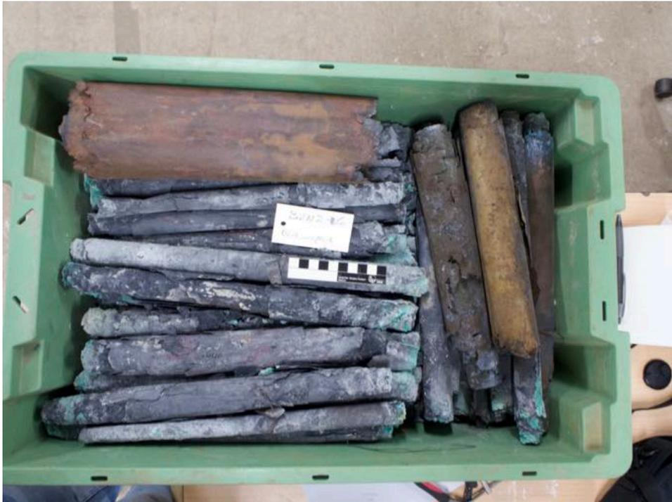
**Abb. 3.34** Messingrollen des Wracks Burgzand II in Amersfoort. Die Rollen lösen sich langsam auf. Nur wenige Rollen (rechts und oben im Bild) konnten beprobung werden. Maßstab = 10cm
