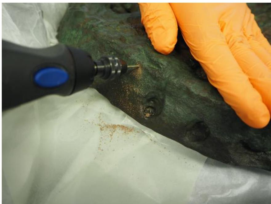
**Abb. 5.1** Probennahme mithilfe eines batteriebetriebenen Dremels und 1,5mm HSS Bohrer. Die metallischen Bohrspäne fallen auf ein Blatt Wägepapier.
