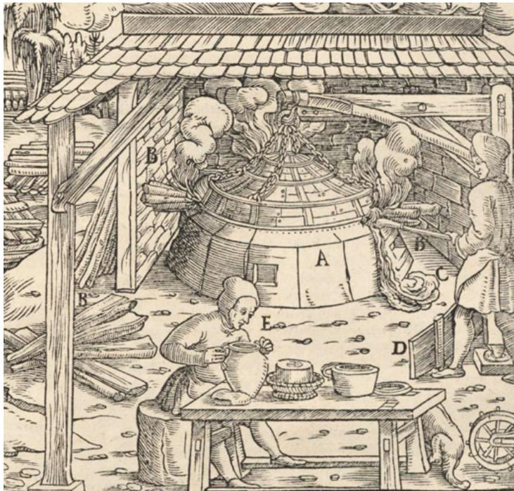
**Abb. 2.18** Die Gewinnung von Silber aus dem Saigerblei auf dem Treibherd (A). Durch partielle Oxidation schwimmt die Bleiglätte (C) auf und wird ständig abgeschöpft. Am Boden des Treibherds lagert sich das Silber ab, der sog. Silberblick (Nach Agricola, 1556).
