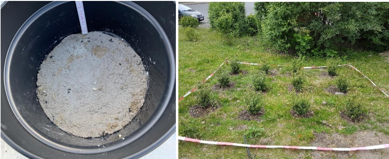
Abbildung 56: Beispielhafte Dokumentation der ZFSV-Oberflächen vor Befüllung mit Blumenerde (links) und im Boden eingesetzte Pflanzkübel (rechts)
