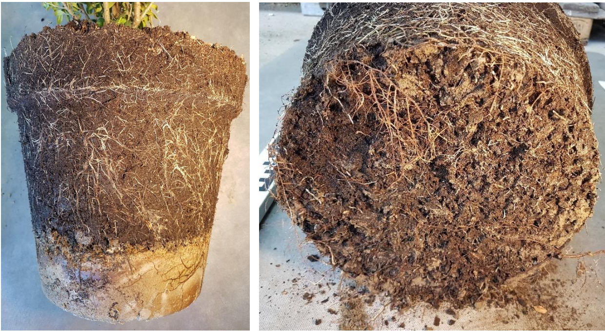
Abbildung 59: Wurzelwachstum in Mutterboden und Trennschicht zwischen ZFSV und Pflanzkübel beispielhaft an Material E (links) und Wurzelwachstum in Trennfläche zwischen Mutterboden und ZFSV beispielhaft an Material D (rechts)
