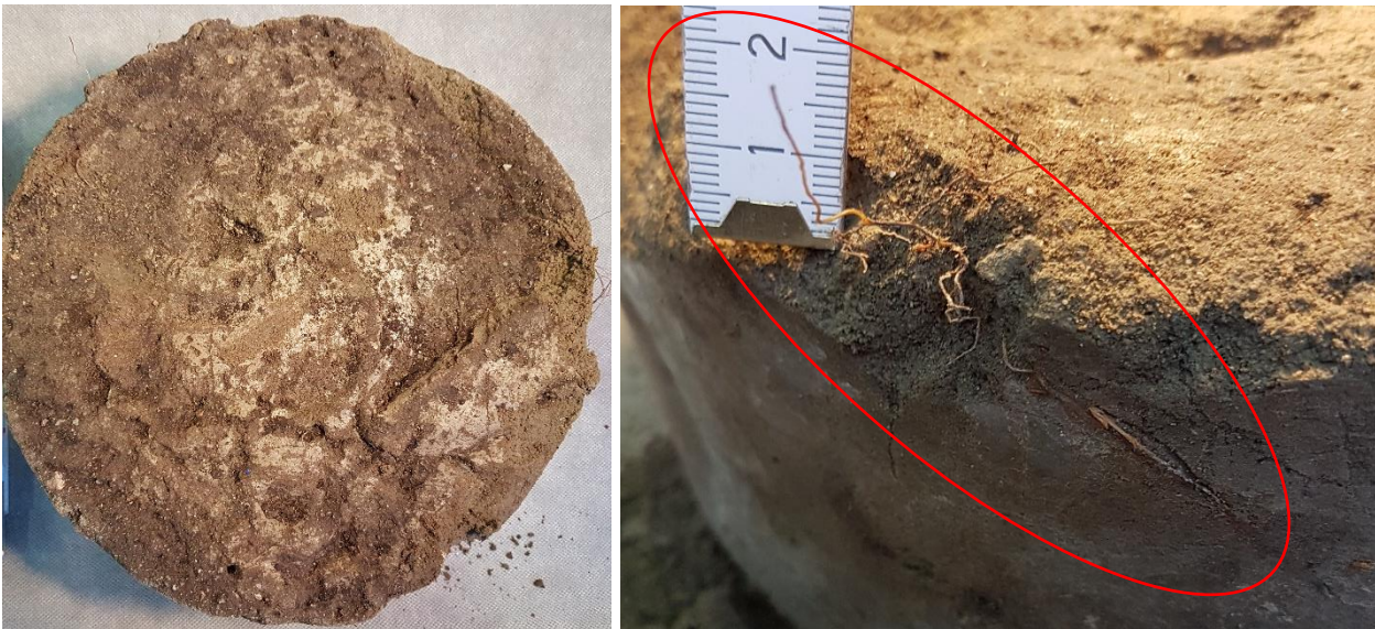
Abbildung 62: Oberfläche ohne aufgeweichte Schicht von Material D (links) und Wurzeleinwuchs im ausgehärteten Material D (rechts)
