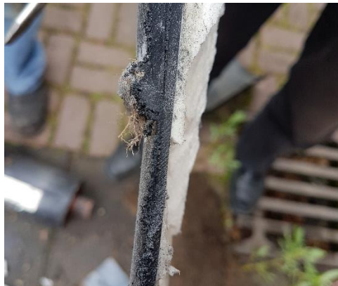
Abbildung 52: Stoffschlüssiger Verbund zwischen Schrumpfmanschette und PE-Außenmantel
