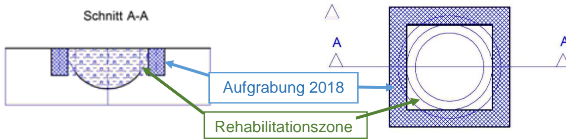
Abbildung 67: Schematische Darstellung der Aufgrabungen 2018 (in Anlehnung an [184, S. 40])
