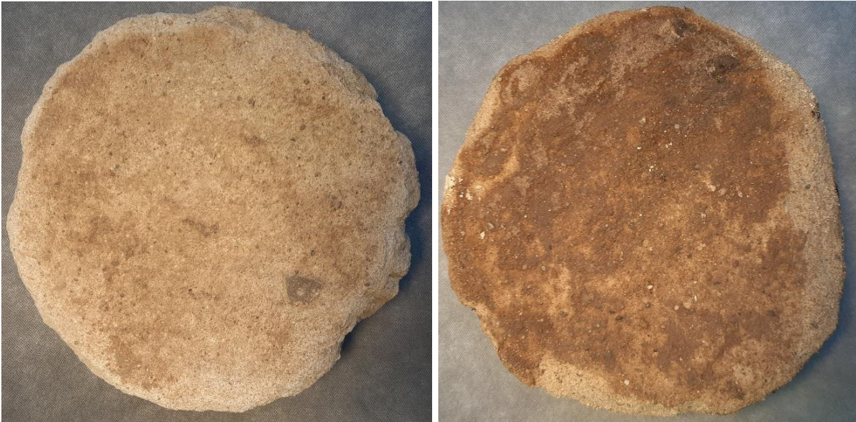
Abbildung 60: Oberfläche ohne aufgeweichte Schicht von Material A (links) und Material B (rechts)
