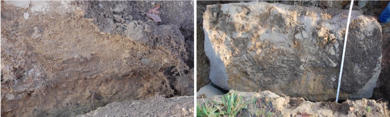
Abbildung 72: Wurzelfilz an Grabenwand (links), umgeworfener ZFSV-Probekörper mit wenigen Erd- und Wurzelanhaftungen (rechts)
