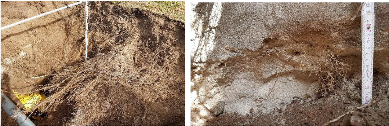
Abbildung 43: Großteil der Wurzelmasse in Baumsubstrat bis 1,5 Meter unter GOK (links) und seit 2013 vereinzelt neu gewachsene Feinwurzeln in der Bettung (rechts)
