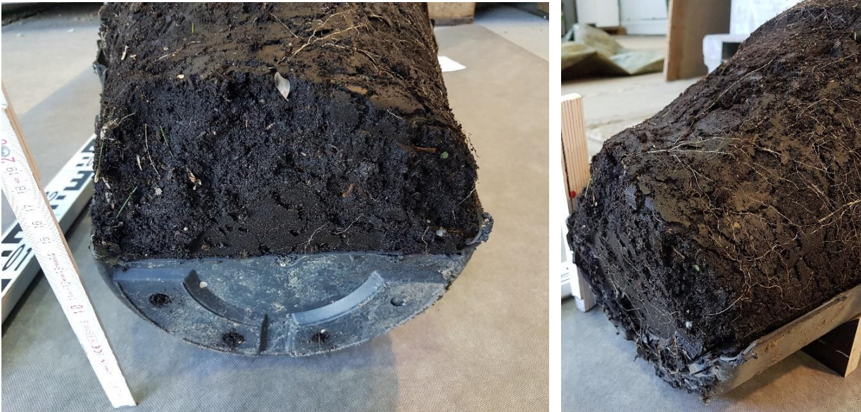
Abbildung 57: Wurzeln bis zur Kübelsohle bei Referenzversuch A
