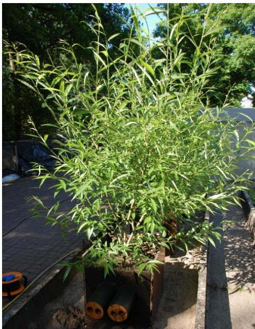
Abbildung 19: Versuchsaufbau zu Auswirkungen des Dickenwachstums von Wurzeln auf Kunststoffmantelrohre: Versuchsbehälter A im Mai 2020 mit ausgeprägtem Wachstum an der Oberfläche (links), Versuchsaufbauschema (rechts) (erstellt durch Grimm (AGFW), angepasst durch den Autor)
