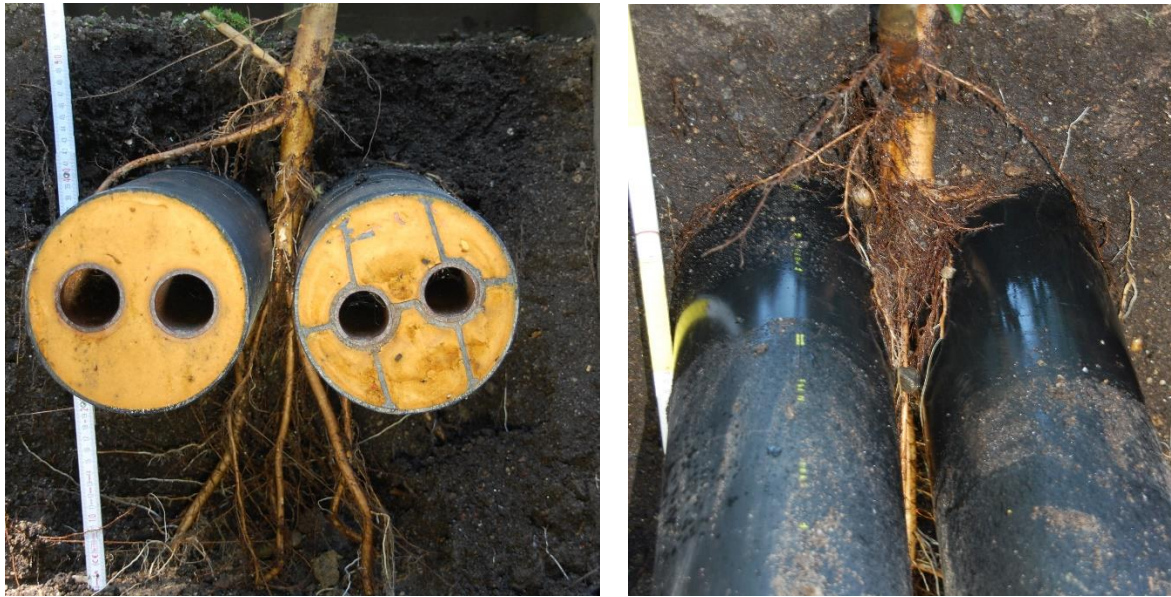
Abbildung 21: Wurzelwachstum zwischen den Rohrleitungen, Versuchsbehälter A, Steckling 1 (Querschnitt, links), Versuchsbehälter C, Steckling 2 (Draufsicht, rechts)
