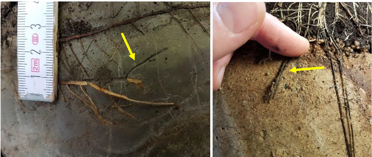
Abbildung 64: Riefen durch Wurzelwuchs in vertikaler Trennfläche zwischen ZFSV und Pflanzkübel in Material D (links) und Material E (rechts)
