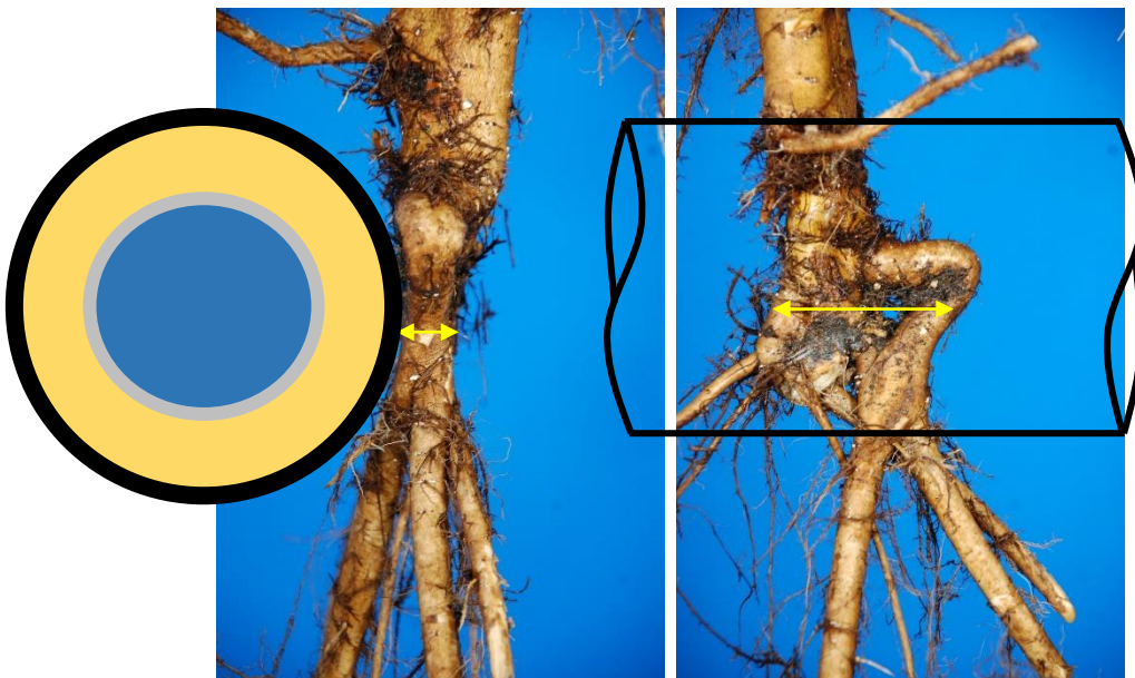
Abbildung 22: Versuchsbehälter C, Steckling 2 Vorderansicht auf radiales Wurzelwachstum von 18,5 mm (links), Seitenansicht auf axiales Wurzelwachstum von 64,0 mm (rechts) jeweils mit gelbem Pfeil markiert (erstellt durch Grimm (AGFW))
