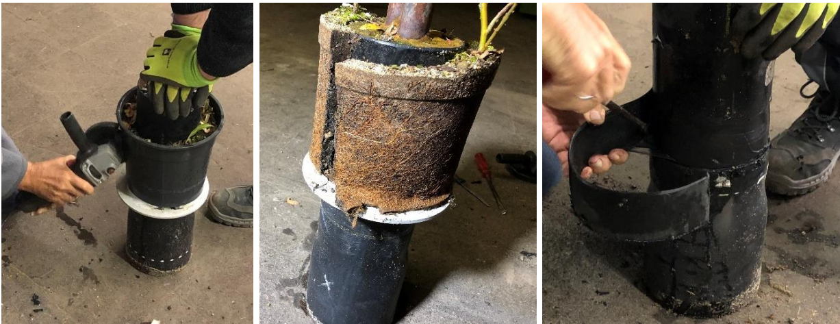
Abbildung 14: Vorgehensweise zur Öffnung der Probekörper (Links: Vertikales Aufschnneiden des Blumentopfes [97, S. 26], Mitte: Vertikales Aufschnneiden des durchwurzelt Substrats [97, S. 26], Rechts: Entfernen der Schrumpfmanschette von der Rohroberfläche bei einer unvernetzten Muffe)
