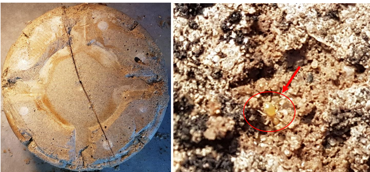
Abbildung 63: Unterseite des ZFSV ohne Wurzeln beispielhaft an Material E (links) und Spinne in aufgeweichter Schicht beispielhaft an Material B (rechts)
