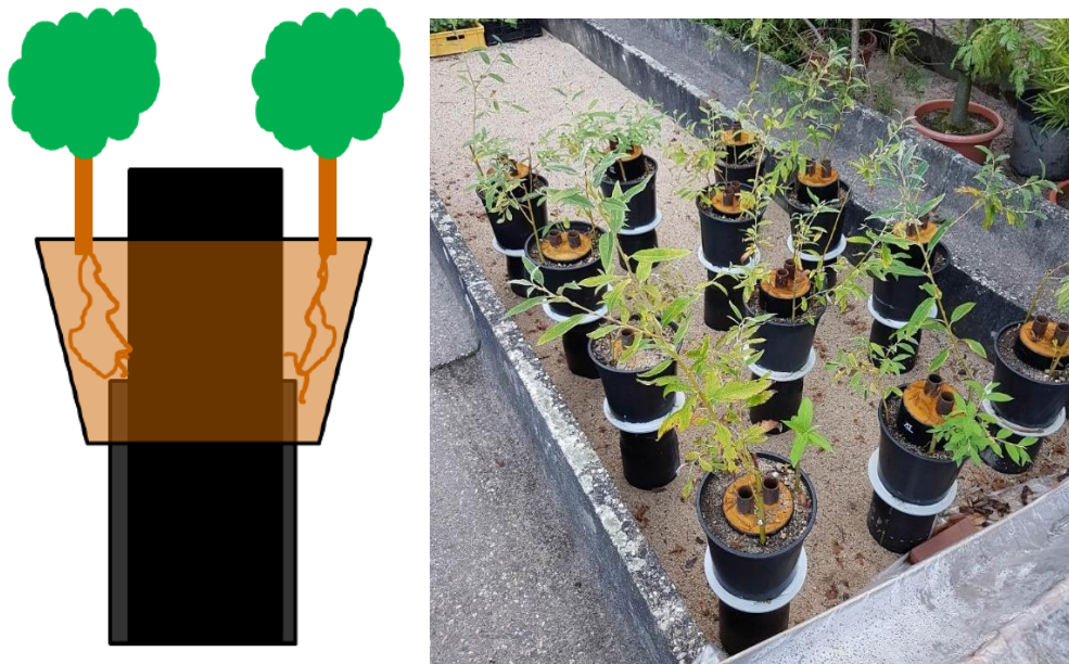
Abbildung 13: Versuchsaufbau zur Wurzelfestigkeit von KMR-Muffenverbindungen (Skizze erstellt durch Grimm (AGFW), Bild rechts [96, S. 44])
