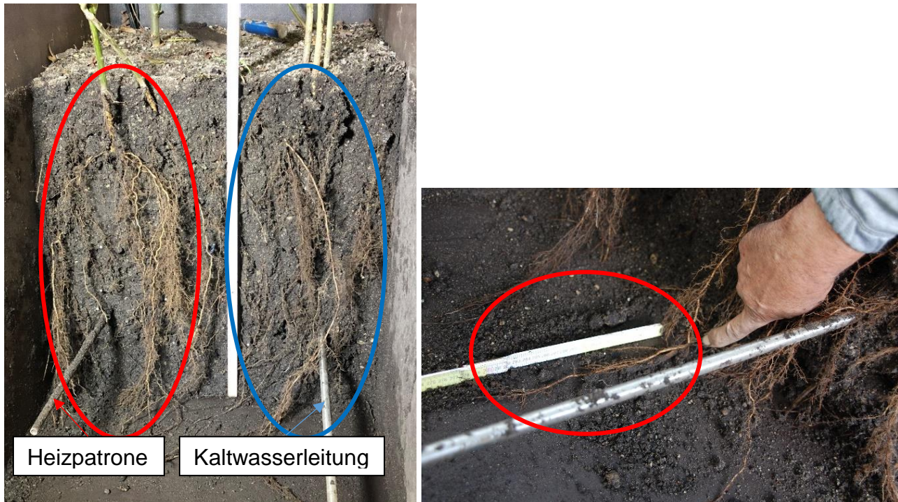
Abbildung 34: Vertikales Wachstum bis zur Versuchsbehältersohle auf Seite der Heizpatrone (rote Einkreisung) und auf Seite der Kaltwasserleitung (blaue Einkreisung) (links) und horizontales Wurzelwachstum an der Versuchsbehältersohle (rechts), beispielhaft dargestellt an Versuchsbehälter C - Reihe 2
