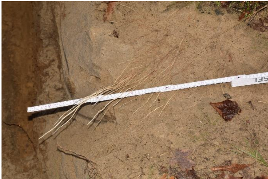
Abbildung 76: Durchwurzelung des nicht festen ZFSV an der GOK am Baumstandort Linde
