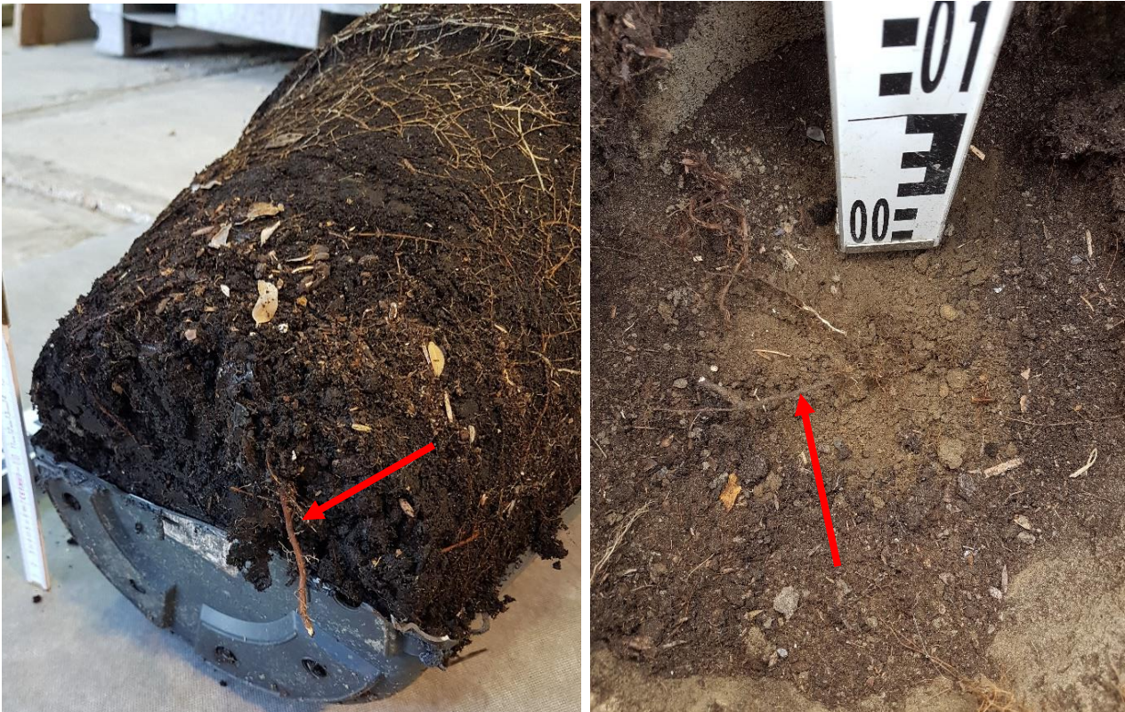
Abbildung 58: Wurzelwuchs in Referenzversuch B mit brauner Wurzel aus Entwässerungsloch – roter Pfeil - (links) und Wurzel mit Seitenwurzeln unterhalb des Pflanzkübels – roter Pfeil -, welche bis zu einer 40 Zentimetern entfernten Pflanze außerhalb des Pflanzkübels zurückverfolgt werden konnte (rechts)
