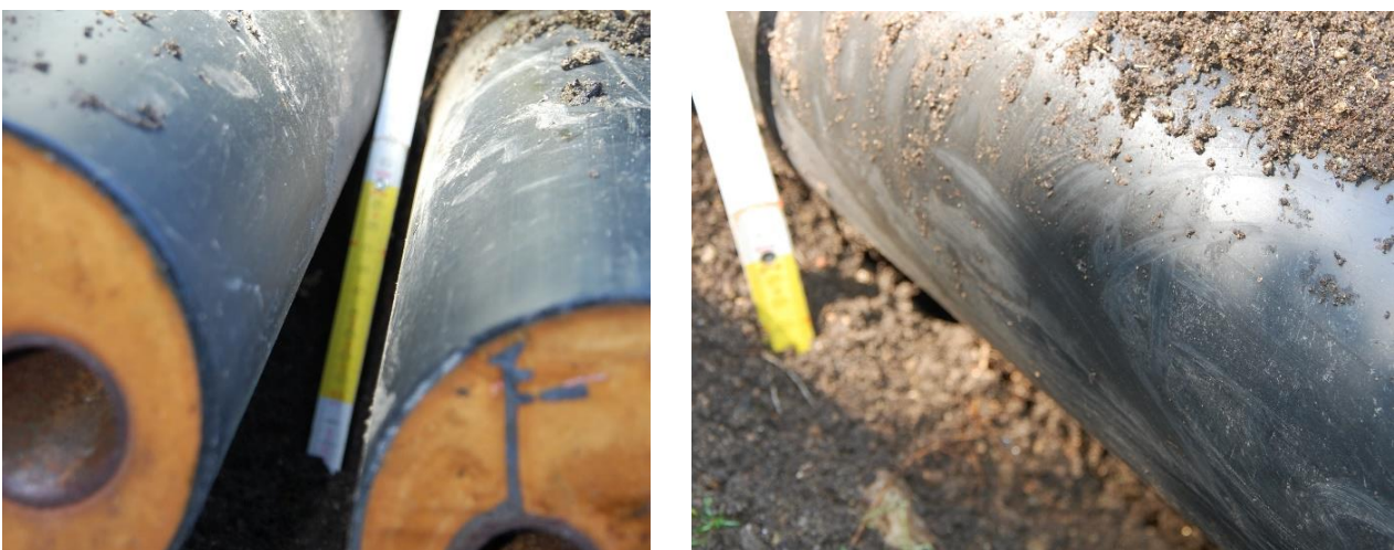
Abbildung 23: Rohrmanteloberflächen aus Versuchsbehälter A (links) und Versuchsbehälter C (rechts)
