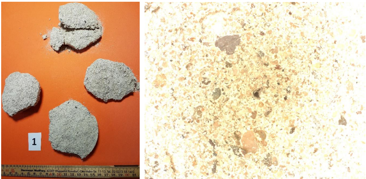
Abbildung 74: Dokumentation der ZFSV-Probestücke (links) und Aufnahme mit 5-facher Vergrößerung der ZFSV-Bruchflächen mittels Mikroskop, in der Mitte eine erkennbare Auffälligkeit in Form eines schwarzen „Flecks“ (rechts)
